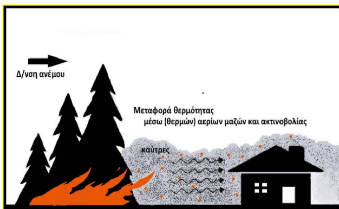
Σχέδιο 4. Τρόποι ροής της θερμότητας σε μια δασική πυρκαγιά, που εξελίσσεται πλησίον κτιρίου και απεικόνιση πιθανού τρόπου μετάδοσης δασικής πυρκαγιάς με μεταφερόμενες καύτρες σε κτίρια παρουσία ισχυρού ανέμου
