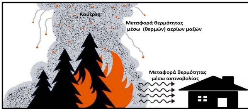
Σχέδιο 2. Τρόποι ροής της θερμότητας σε μια δασική πυρκαγιά, που εξελίσσεται πλησίον κτιρίου και απεικόνιση πιθανού τρόπου μετάδοσης δασικής πυρκαγιάς με μεταφερόμενες καύτρες σε κτίρια χωρίς την παρουσία ανέμου υπό συνθήκες πρόσκαιρης νηνεμίας, ή ατμοσφαιρικής ευστάθειας
