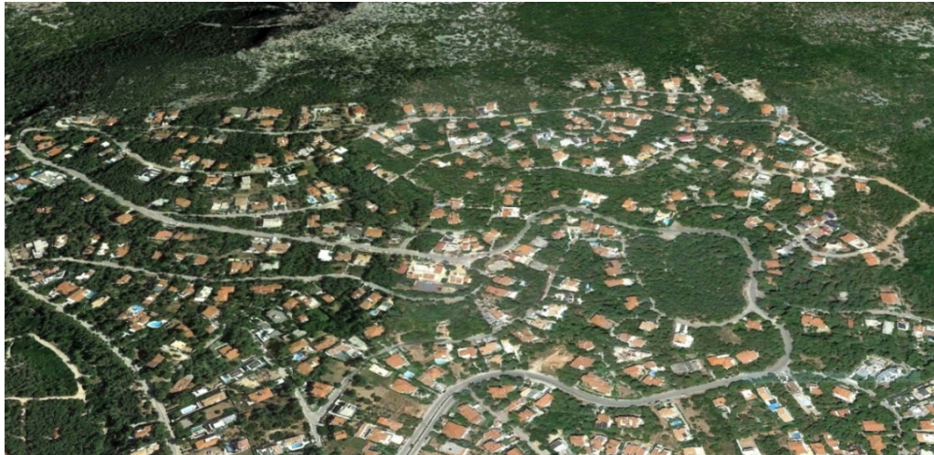
Εικόνα 2. Δομημένη περιοχή που κατά το παρελθόν έχει αναπτυχθεί εντός δάσους ή δασικής έκτασης και τα κτίσματα που την συγκροτούν έχουν μεγάλη εγγύτητα με καύσιμα δασικής προέλευσης.
